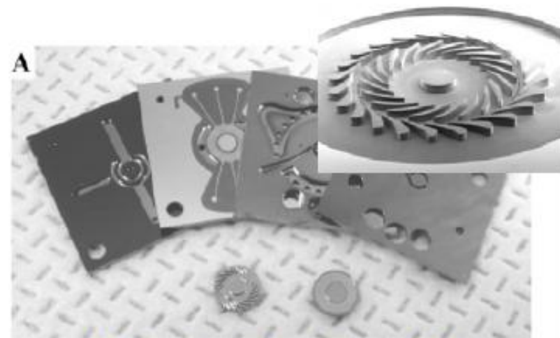
Microturbine, Schmidt group MIT
