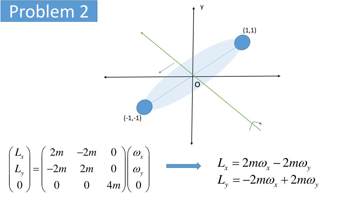
$$\begin{split} L_x &= 2m\omega_x - 2m\omega_y \\ L_y &= -2m\omega_x + 2m\omega_y \\ \vec{L} &= \vec{L}_x i + \vec{L}_y j \\ \vec{L} &= (2m\omega_x - 2m\omega_y)i + (-2m\omega_x + 2m\omega_y)j \\ \vec{\omega} &= \omega_x i + \omega_y j \end{split}$$
